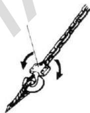
Avant d'appliquer une charge, tournez le levier du crochet de manière à supprimer le nœud dans la chaîne de charge.
