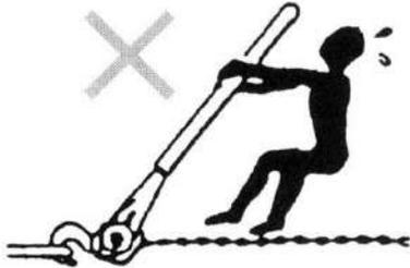
b) N'attachez pas de tuyau ou d'outil du même style au levier de manœuvre afin de l'allonger.
