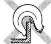
La charge ne peut être soutenue par l'extrémité avant du crochet.
