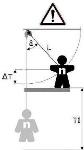
S'écartez de la verticale par rapport à l'antichute nécessite l'augmentation du tirant d'air.
